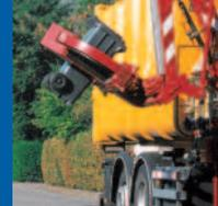
In den Stadtteilen **Angermund, Wittlaer, Kalkum, Unterbach und Hubbelrath** wird für die Leerung der **60–240 l Restmülltonnen** ein Seitenlader eingesetzt. Die Leerung der Behälter erfolgt mit einem automatischen Greifarm, der mithilfe einer Videokamera gesteuert wird. Damit die Tonnen in den o.g. Teilservicegebieten vom Seitenlader problemlos erfasst werden können, sind wir auf die aktive Mithilfe der Bürgerinnen und Bürger angewiesen.
